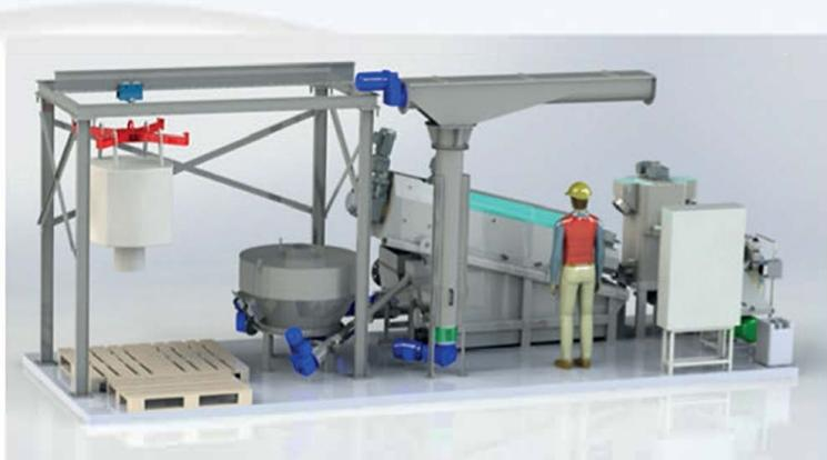
Afin de répondre aux nouveaux besoins de normaliser les boues urbaines avec leur épandage selon l'arrêté du 20 avril 2021, Terréo a développé en partenariat avec AMCON Europe pour la partie déshydratation et SODIMATE pour la partie chaulage, un dispositif mobile avec opérateur dans le respect des prescriptions et analyses visées par l'arrêté.
