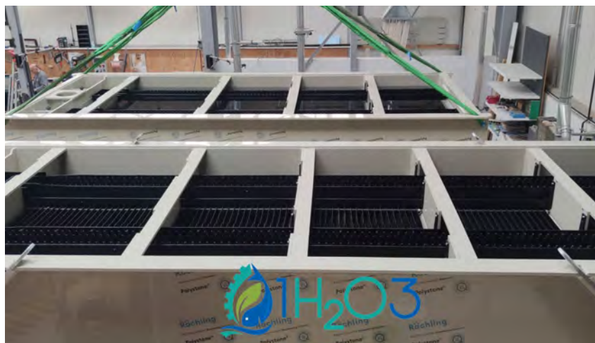
Des tests en eau sont réalisés sur des décanteurs lamellaires de 1h2o3 pour valider la solidité et la conformité à la directive machine CE, une étape obligatoire avant livraison.
