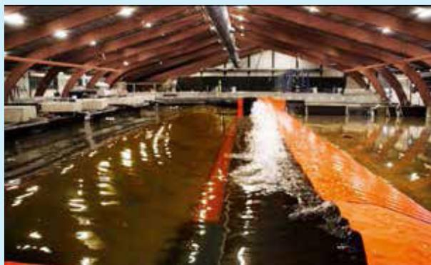
Alors que l'eau pèse environ 1000 kg par mètre cube et qu'en situation statique, elle pousse une barrière de protection anti-inondation avec une force de 400 kg, la force est à peu près doublée dans des scénarios de tempêtes extrêmes.
