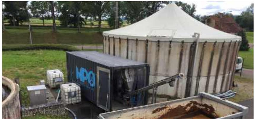
Sur le marché du traitement mobile des boues de STEP, MPO propose la technologie de la presse à vis, en développant des conteneurs autour d'une machine Huber Technology.
