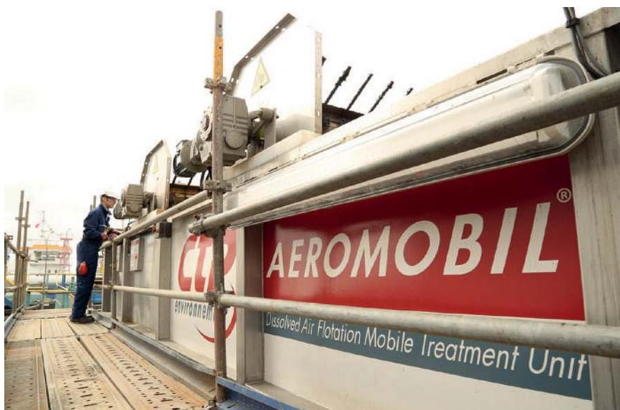
**Fruit de deux années d'études et de recherches, l'unité Aeromobil de CTP Environnement est une station de traitement physico-chimique innovante et intégrée de flottation à air dissous capable de traiter jusqu'à 1 000 m<sup>3</sup>/h.**
